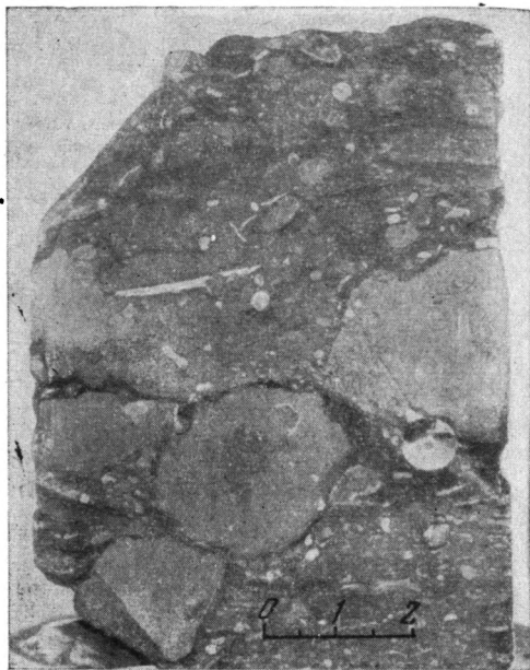
Фиг. 2. Глинистый органогенно-обломочный известковистый доломит с включениями обломков рифогенных светло-серых известняков (полированный шлиф)
