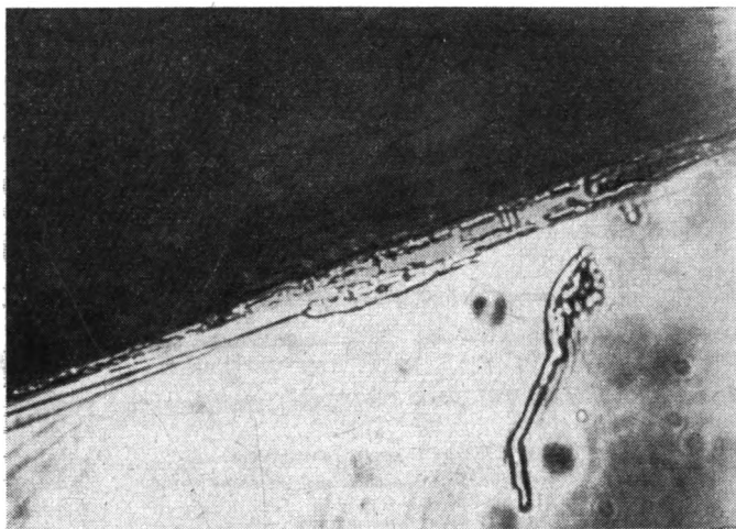
Фиг. 5. Обломок каменистой разновидности асбеста. Мембранная опаловая трубка и «хвост» волосовидных кристаллов родусит-асбеста. Видны отверстия и кольца. Иммерсия, \times 2000
