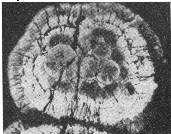
Фиг. 7. Пирит — мельниковитовая сферическая конкреция с глобулярной структурой. Аншлиф, светлое — пирит, серое — мельниковит
