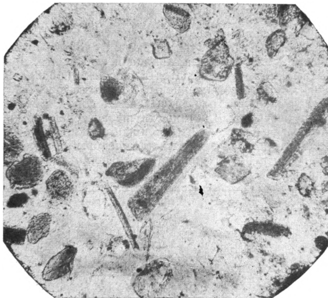
Фиг. 1. Фтанит с алевритовыми зернами фосфорита, кварца и игловидным фосфатным детритом хиолитов
