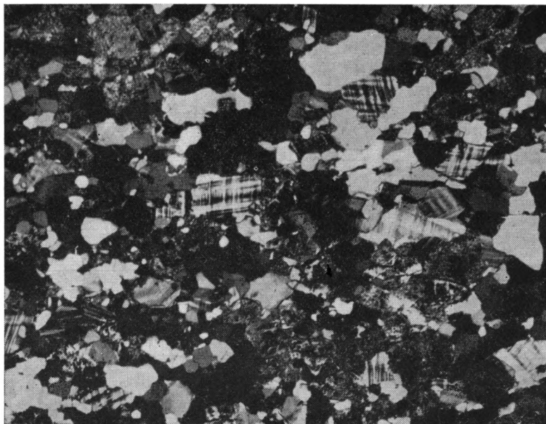
Фиг. 2. Гранито-гнейс, плагиоклаз серицитизирован
