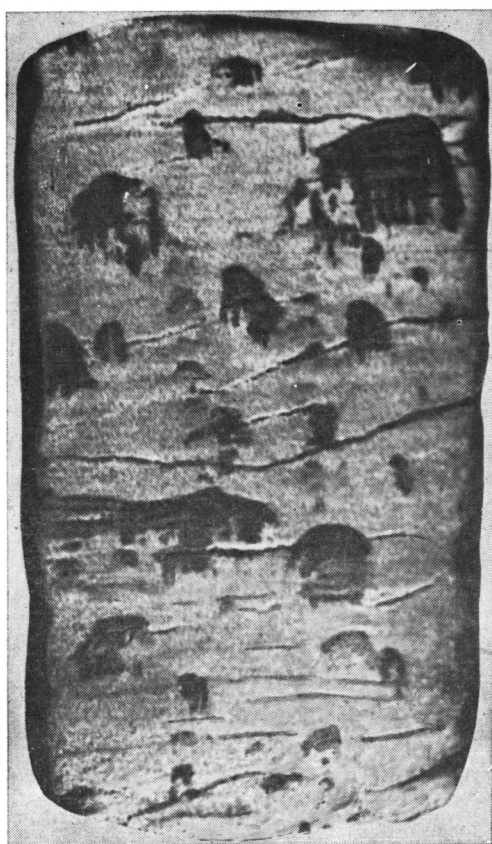
Фиг. 7. «Лапчатая» форма выщелачивания в нефтенасыщенном алевритовом песчанике Абдрахмановская пл., скв. 14018, пласт D 1 г., увел. 1,6
