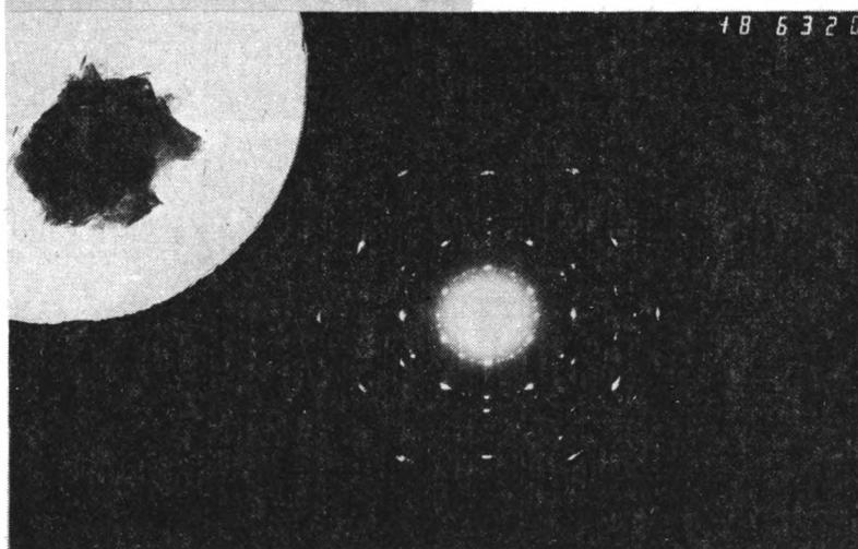
Фиг. 4. Электронно-микроскопическое изображение, микродифракционная картина и энерго-дисперсионные спектры первой группы частиц слоистого силиката
