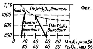
Фиг. 4. Фазовая диаграмма системы  $\text{Fe}_2\text{O}_3 - \text{Mn}_2\text{O}_3$  [17]
