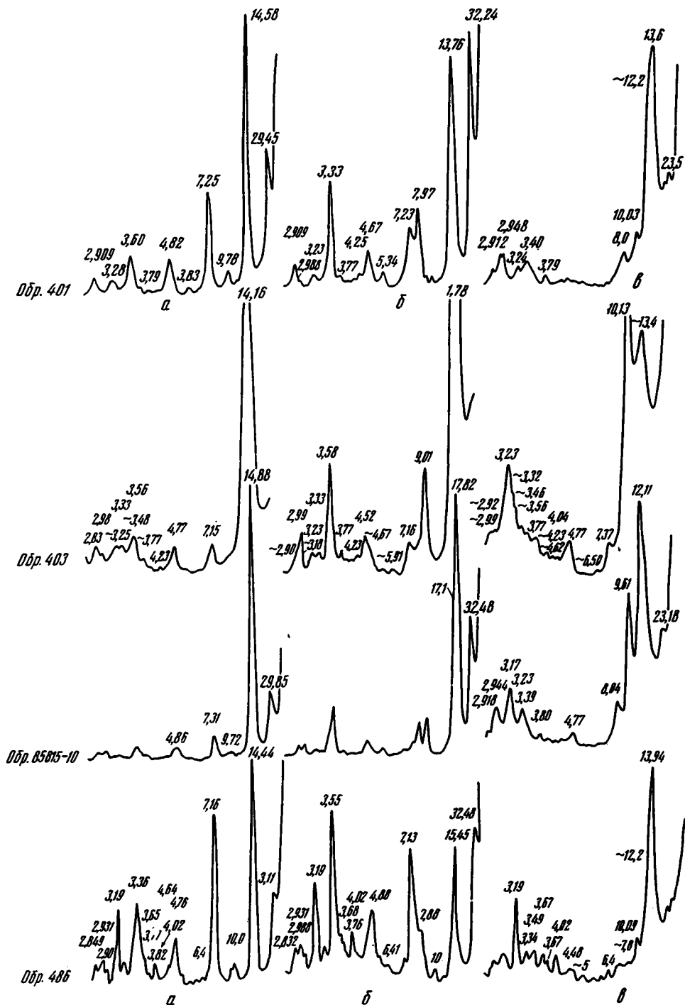
Фиг. 8. Рентгеновские дифрактограммы глинистой фракции шощонитовых базальтов: а — воздушно-сухой препарат; б — насыщенный глицерином; е — прокаленный при 550°C
