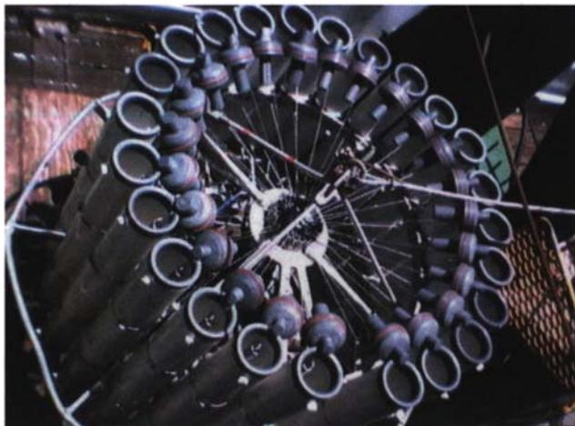
Вид сверху батометров в комплексе «Розетт» (“Rosette”) (<http://test.oceanographers.ru/?p=1497>)
