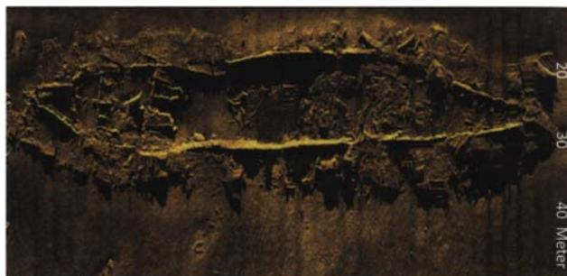
Пример сонарного изображения затонувшего корабля. Глубина — 50 м. Рабочая частота 900 kHz (<https://www.edgetech.com/underwater-technology-gallery/#side-scan-gallery>)
