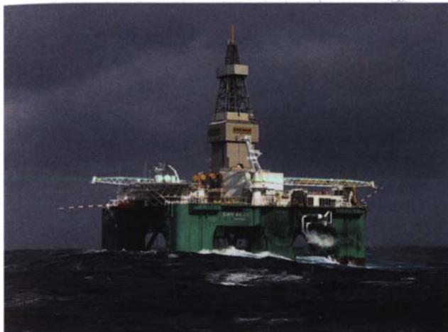
Полупогружная буровая платформа (<http://www.fish-safe.eu/en/offshore-structures/photo-gallery.aspx>)
