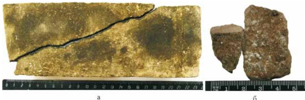
Рис. 1. Фото поверхности спила известняка турнейского яруса, секущегося субвертикальной тектонической трещиной (а), и поверхности стенки раскрытой трещины, по которой развивается аутигенный кальцит (б)
