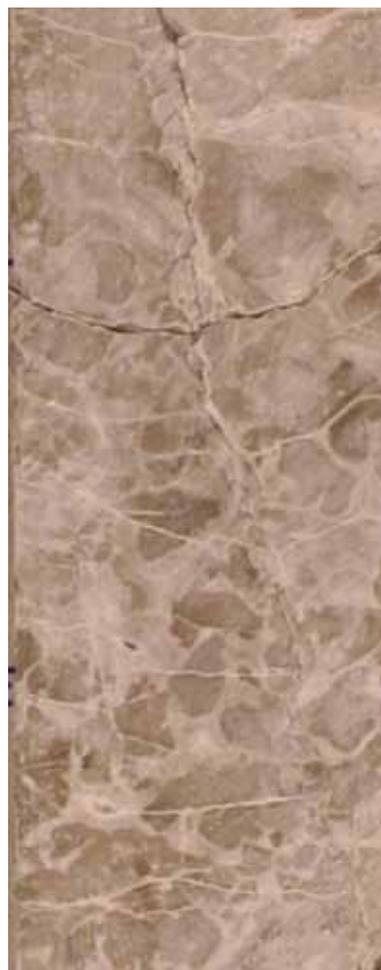
Рис. 3. Известняк псевдообломочный трещиноватый рифового склона. Фото керна
