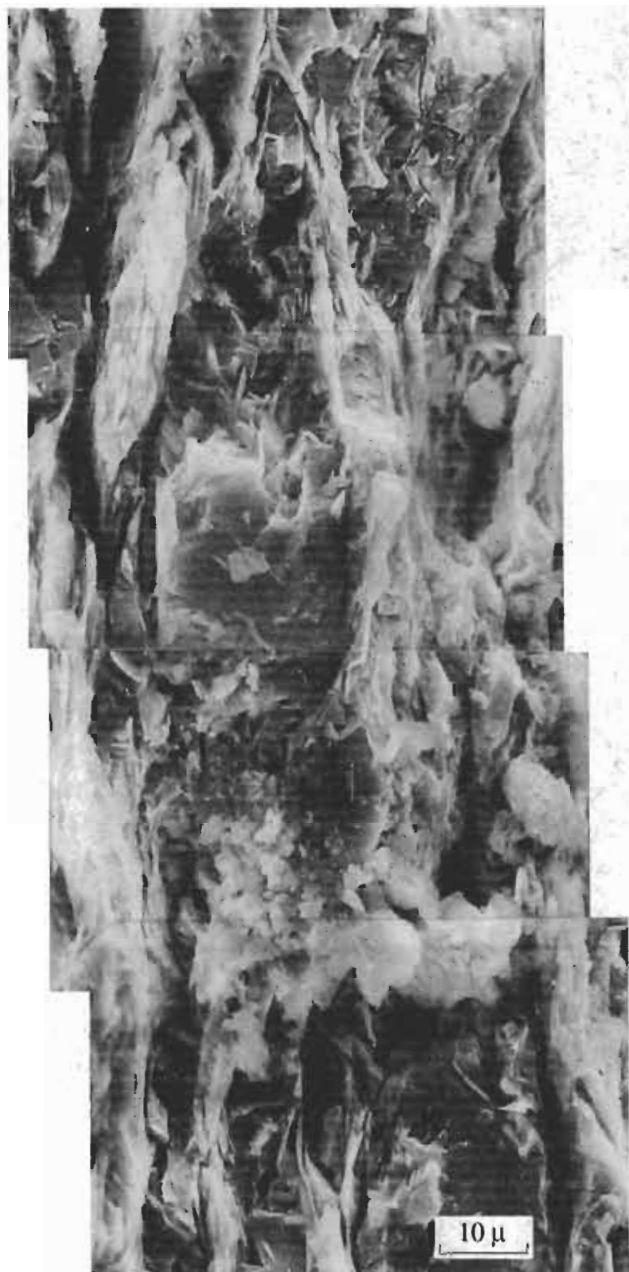
Рис. 4. Микрофотография (сканирующий микроскоп) глинисто-алевритовых сланцев из зоны развития интенсивного кливажа блока IV северной части профиля (обр. № 394, см. рис. 2, 3).
