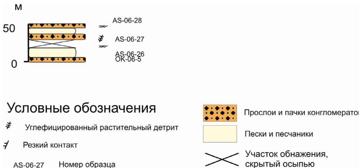
Рисунок 3.43. Литологическая колонка отложений напанской свиты в разрезе по р. Половинке. Нанесены номера образцов, по которым проводился подсчёт состава песчаников.
