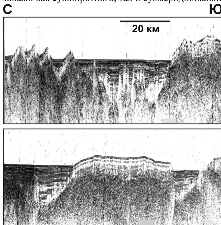
**Рис.4.** Примеры записи непрерывного сейсмического профилирования (НСП), иллюстрирующие деформации осадочного чехла, связанные с вертикальным подъемом блоков фундамента (штамповая складчатость), формированием чешуйчато-надвиговых структур, сдвиговых деформаций в пассивных частях трансформных разломов, структур протыкания и флюидным режимом, формирующем осветления сейсмической записи (9-й рейс НИС «Академик Николай Страхов», 1989 г.) (Соколов, Мазарович, 2009).
