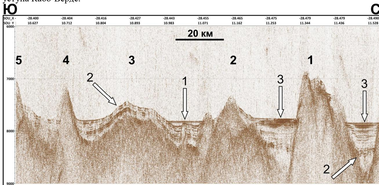
**Рис.25.** Разрез НСП S22-PCV-02 22-го рейса НИС «Академик Николай Страхов» (ГИН РАН, 2000) вкост хребтов к югу от уступа Кабо-Верде. Положение разреза показано на рис.24. Пронумерованы хребты с севера на юг. Стрелками указаны: 1 – вертикальное осветление записи; 2 – пликативные деформации; 3 – осадки с повышенной отражающей способностью.
