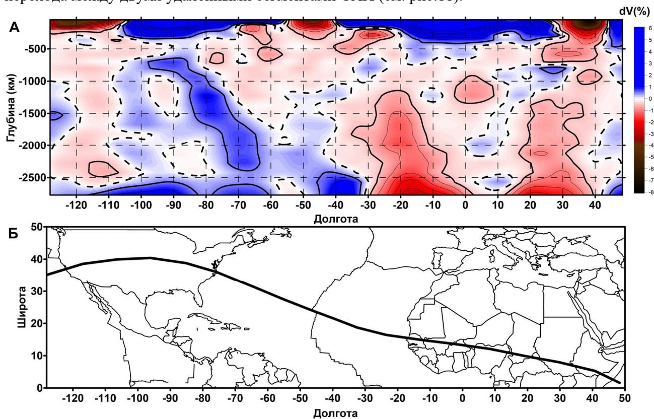
**Рис.10.** Субширотный сейсмотомографический разрез мантии (А) в центральном сегменте Атлантики, рассчитанный по данным (Boschi, 2002; Grand et al., 1997), пересекающий САХ по 24°с.ш. (пунктирная изолиния – нулевое значение, жирные сплошные изолинии – пределы  $\pm 0.5\%$  и далее с этим шагом); положение профиля, совпадающее с горизонтальной координатой разреза (Б).
