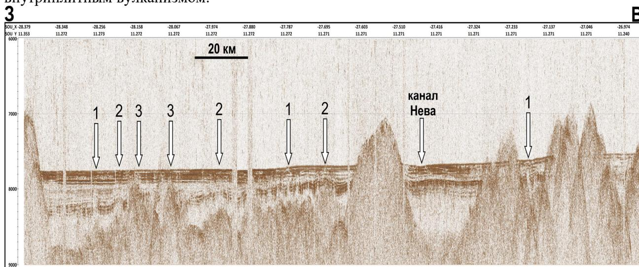
**Рис.26.** Разрез НСП S22-PCV-08 22-го рейса НИС «Академик Николай Страхов» (ГИН РАН, 2000) вдоль трога между хребтами 1 и 2. Положение разреза показано на рис.5.14. Стрелками указаны: 1 – вертикальное осветление записи; 2 – пликативные деформации; 3 – структура протыкания.
