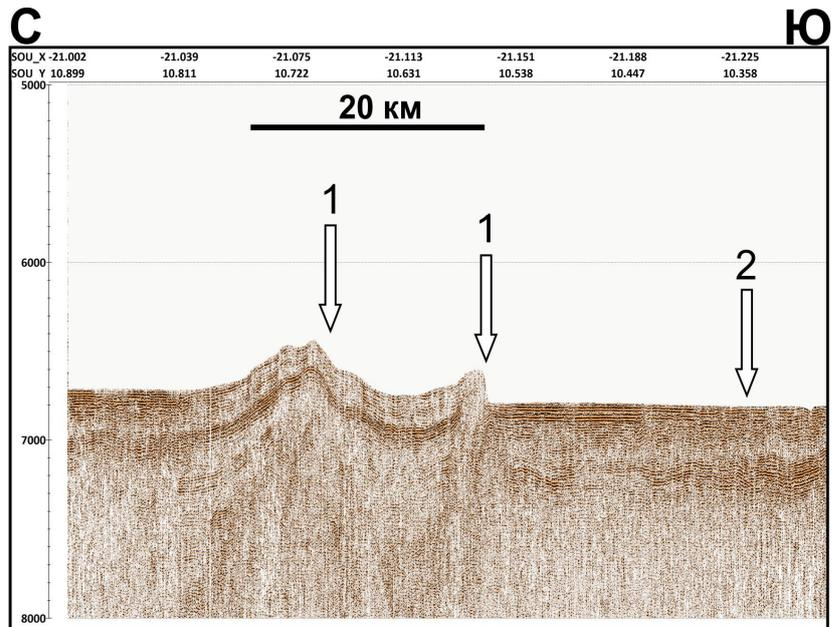
**Рис.28.** Фрагмент разреза НСП S23-P1-3 23-го рейса НИС «Академик Николай Страхов» (ГИН РАН, 2006) (Отчет 23-го..., 2006; Сколотнев и др., 2007) вкост юго-восточного обрамления котловины Зеленого Мыса. Положение разреза показано на рис.27. 1 – взбросо-надвиговые нарушения; 2 – пликативные палеодеформации.
