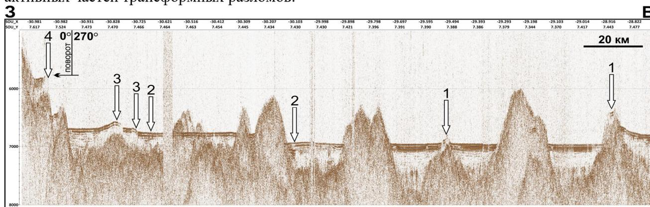
**Рис.23.** Разрез НСП S22-7В 22-го рейса НИС «Академик Николай Страхов» (ГИН РАН, 2000) вдоль восточной пассивной части разлома 7°24'с.ш. 1 – современные деформации; 2 – палеодеформации; 3 – взбросовые нарушения; 4 – сбросовые нарушения.
