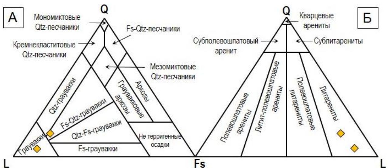
Рис. 4.20. Треугольные классификационные диаграммы для песчаников Чарской зоны по Шутов, 1967 (А) и Folk, 1980 (Б).
