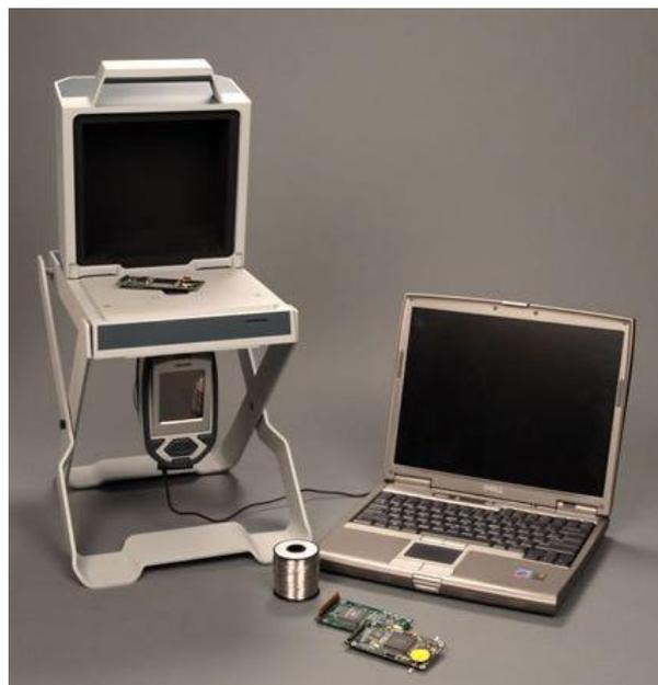
Рис. 1. Анализатор Niton XL3t900, закрепленный на защитном стенде.
